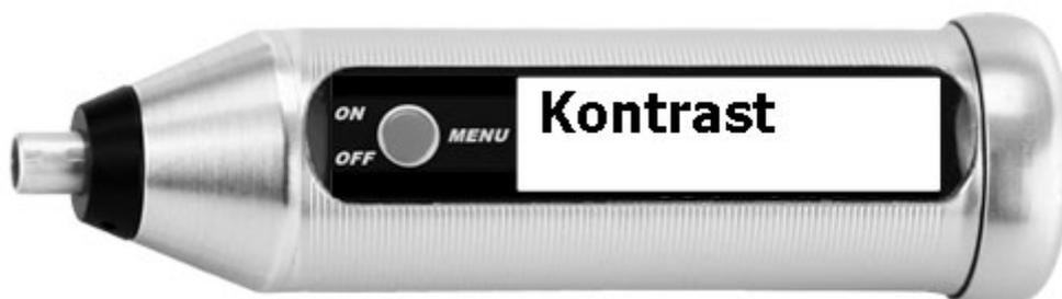
Der Kontrast der Anzeigeschrift kann auf einer Skala von 0 (kontrastarm, dunkel) bis 4 (kontrastreich, hell) eingestellt werden. Der aktive Kontrast wird mit einem Stern (\*) hinter dem Eintrag dargestellt.
