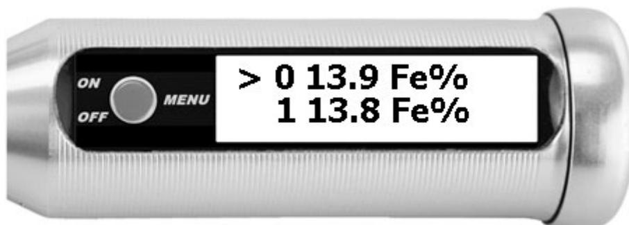
Dieser mit dem Dreieck markierte Messwert kann durch langen Tastendruck gelöscht werden. Er wird danach durchgestrichen dargestellt. Ein durchgestrichener / gelöschter Wert wird nicht mehr in die Statistik einberechnet und wird nicht mehr zum PC oder zur mobilen App übertragen.
