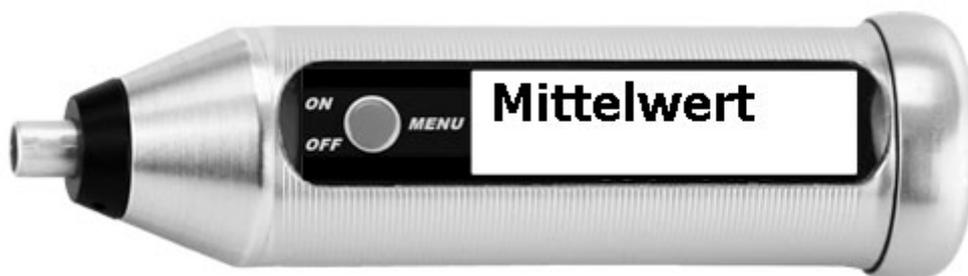
Bei der Mittelwertmessung werden permanent Messwerte aufgezeichnet und arithmetisch gemittelt. So können Sie das Gerät über ein Werkstück ziehen und sehen jeweils den aktuellen Wert, wie auch den Mittelwert aller bisher gemessenen Werte. Nach dem Abheben der Sonde und erneutem Aufsetzen wird der Mittelwert zurückgesetzt.
