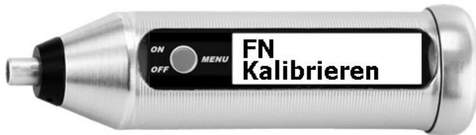
Die FN-Kalibrierung wird normalerweise auf dem Kalibriernormal mit dem höheren angegebenen FN-Wert durchgeführt.
