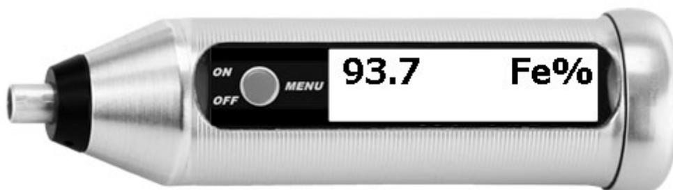
Bei Wechsel der Messart zur Mittelwertmessung (**Messart / Mittelwert**) werden der aktuelle Einzelwert und der Durchschnittswert der Messreihe seit dem letzten Aufsetzen der Sonde angezeigt.
