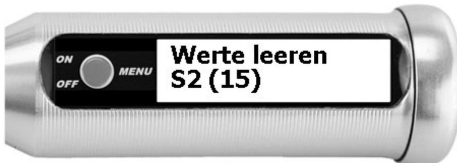
Der Speicher wird geleert. Alle Messwerte werden entfernt. Der Speicher bleibt aber bestehen und wird nicht gelöscht. Wenn der Speicher zuletzt aktiv war, bleibt er aktiv und wird ab der nächsten Messung erneut gefüllt.
