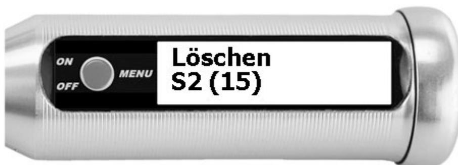
Der Speicher wird gelöscht. Die Speichernummer (hier Nummer 2) kann später durch Anlegen eines neuen Speichers wiederverwendet werden.
