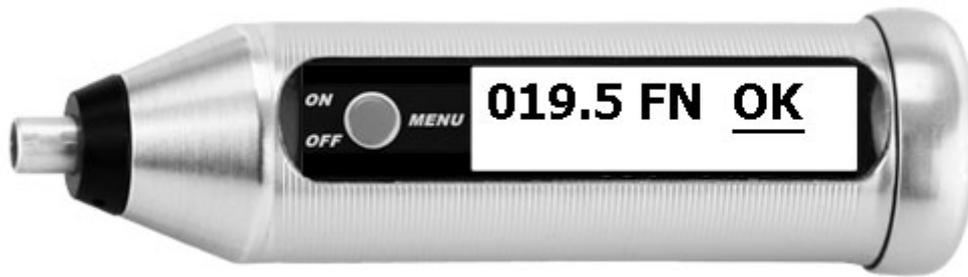
Mit einem letzten langen Druck bei OK verlassen Sie die Einstellung des FN-Werts.
