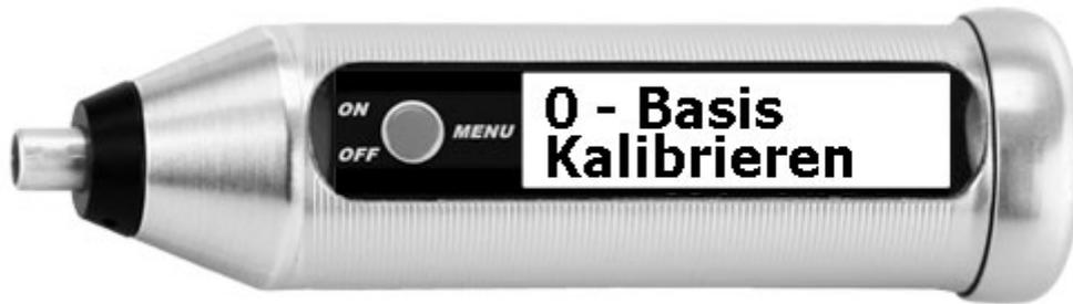
Die Basiskalibrierung wird als Nullkalibrierung bezeichnet, obwohl ihr Ergebnis nicht FN 0 ist, sondern FN 140. FN 140 entspricht 100% Fe und ist der Wert von Volleisen oder gesättigtem Ferritmaterial.
