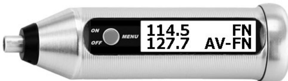
Auch bei Messeinheit Fe% können Sie die Mittelwertmessung nutzen.
