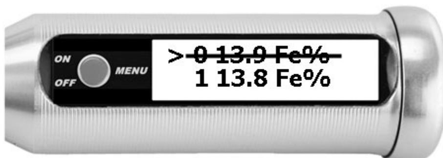
Ein gelöschter Wert kann mit erneut mit langem Tastendruck reaktiviert werden. Erst durch **Bereinigen** wird der durchgestrichene Wert endgültig gelöscht.
