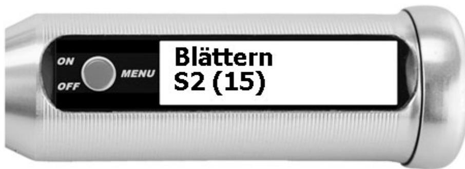
In der Blätterfunktion werden alle Messwerte des Speichers angezeigt. Es werden immer 2 Werte angezeigt und bei Tastendruck wird um einen Wert weitergeblättert. Die obere Zeile ist mit einem Dreieck links markiert.
