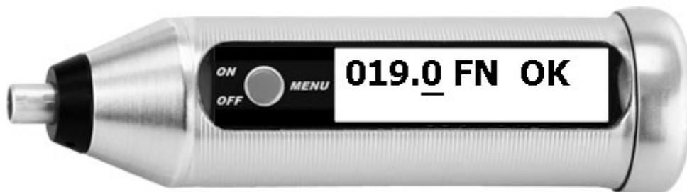
Zweiter Schritt: der Balken steht unter einer Zahl. Drücken Sie jetzt lang, die Zahl beginnt zu blinken. Drücken Sie jetzt so oft kurz, bis der gewünschte Wert erreicht ist.
