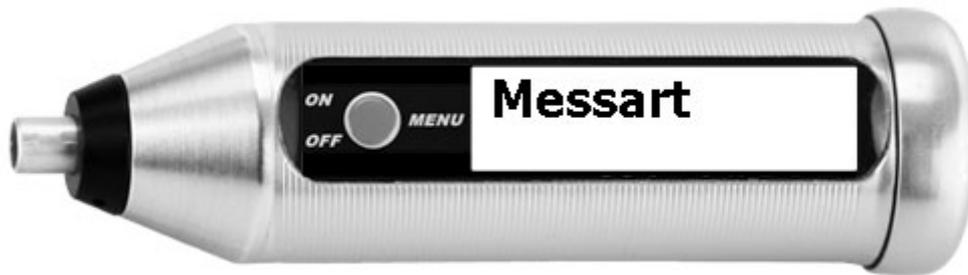
Bei den Messarten kann die Mittelwertmessung aktiviert werden, oder wieder zur voreingestellten Normalmessung zurückgekehrt werden.
