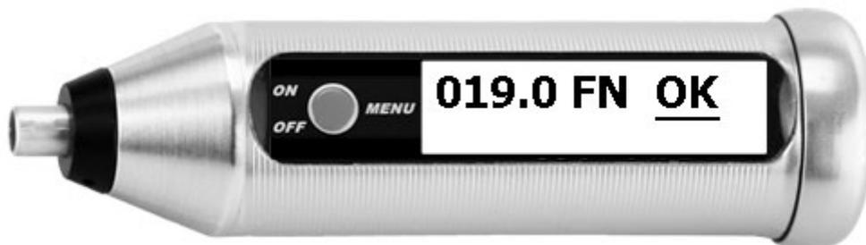
Erster Schritt: der Balken steht unter **OK**. Drücken Sie jetzt kurz, solange bis der Balken unter einem Feld steht, dass Sie ändern wollen.
