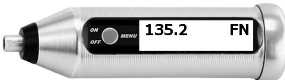
Durch Wechsel der Messeinheit (**Einstellung / Messeinheit**) kann die Messung auch in Fe% dargestellt werden.
