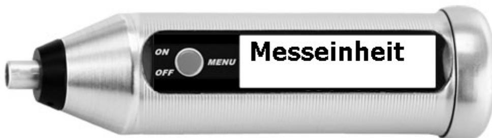
Wechsel der Messeinheit zwischen FN und Fe%.
