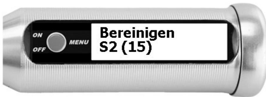
Der Speicher wird bereinigt. Gelöschte einzelne Messwerte werden entfernt und sind beim Blättern nicht mehr sichtbar. Die Nummerierung der Messwerte ist jetzt wieder ab Nummer 1 lückenlos aufsteigend.
