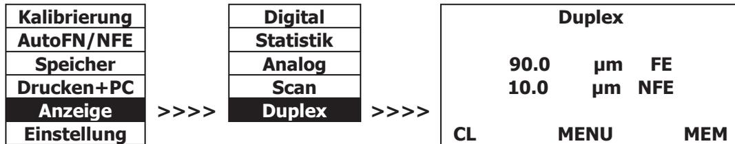
Die Duplex-Messfunktion ist ideal zur Messung von Zweifachbeschichtungen, z.B. Bestimmung der Schichtdicke von isolierenden Beschichtungen auf verzinktem Stahl.
