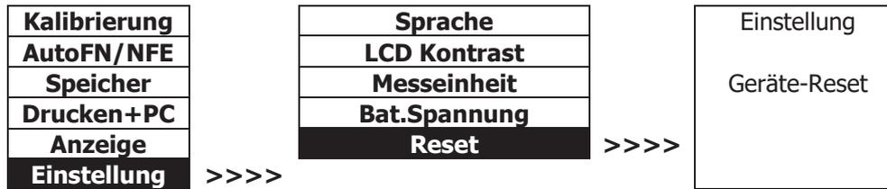
Reset setzt alle Einstellungen des Gerätes auf die Werkseinstellungen zurück. Diese Funktion sollte dann angewendet werden, wenn Einstellungen verändert worden sind und das Gerät unsachgemäß arbeitet oder die Kalibrierung der Sonde nicht richtig funktioniert.
