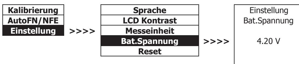
Die Batteriespannung sollte über 3.0 V liegen.
