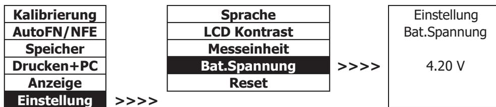
Die Batteriespannung sollte über 3.0 V liegen.
