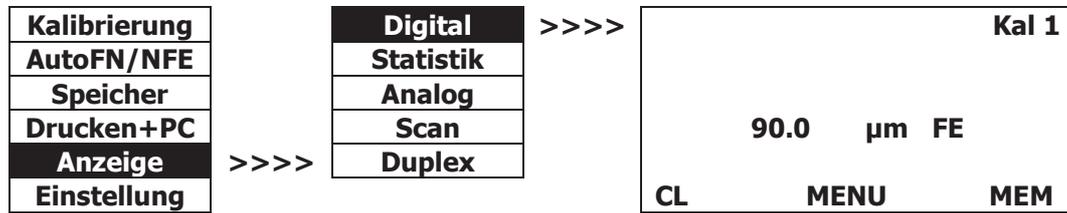
Standardmäßig ist die normale Digitalanzeige aktiviert. Hier wird der aktuelle Messwert angezeigt, aber nicht automatisch gespeichert. Um den angewählten Messwert zu speichern, die rechte blaue Taste **MEM** einmal drücken. Ein falscher Messwert kann mit der linken blauen Taste **CL** gelöscht werden.
