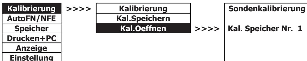
Mit den Pfeiltasten Kalibrierspeicher Nr. 1-3 wählen, danach mit Taste **OK** die Kalibrierung öffnen. Der verwendete Kalibrierspeicher wird in der Anzeige oben rechts angezeigt.
