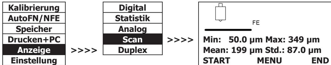
Die Scan-Messfunktion dient zur genauen Ermittlung des Mittelwertes der Schichtdicke auf rauen Oberflächen oder rauen Beschichtungen.
