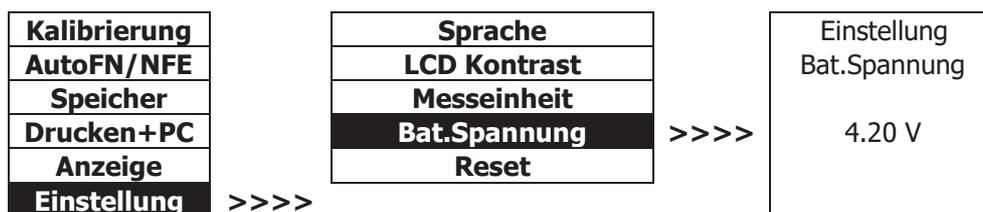
Die Batteriespannung sollte über 3.0 V liegen.
