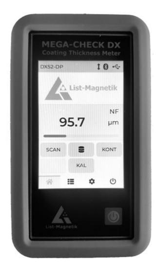
Sie sehen im mittleren Bereich den Messwert, die Metallart (FE/NF) und die Messeinheit ( $\mu$ m oder mils). Links wird der aktuell aktive Speicher und seine Befüllung angezeigt.
