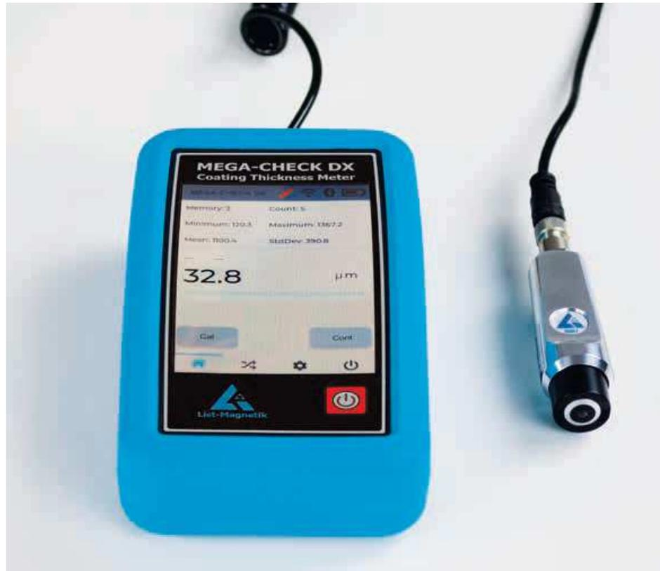
Die Scan-Funktion erlaubt das Abtasten eines Werkstücks über eine raue Fläche und statistische Auswertung der Daten. Mit der zusätzlichen Analoganzeige wird die Visualisierung der Messwerte ergänzt, um auch aus den Augenwinkeln Tendenzen und Spitzenwerte zu erkennen.
