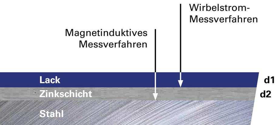
Zum Messen der Dicke von Schichten über einem Metalluntergrund kommen zwei Messtechniken zum Einsatz: Erstens die magnetinduktive, wenn der Untergrund selbst magnetisierbar ist (Stahl oder Eisen), zweitens das Wirbelstromverfahren, wenn der Untergrund zumindest elektrisch leitend ist (sonstige Metalle wie z.B. Aluminium). Wir beschränken uns auf diese beiden Techniken. Deshalb können wir Ihnen leider keine Geräte für die Schichtdickenmessung über Keramik, Glas oder Kunststoff anbieten.
